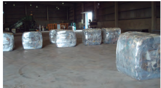
Procés de composició a pressió de les bales de residus, com a combustible emmagatzemat en bales d'una tona
