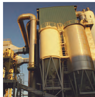
Sitges on es recullen cendres, l'únic residu que genera el procés, fins que es puguin recuperar com a material constructiu, com es fa amb l' escograva
