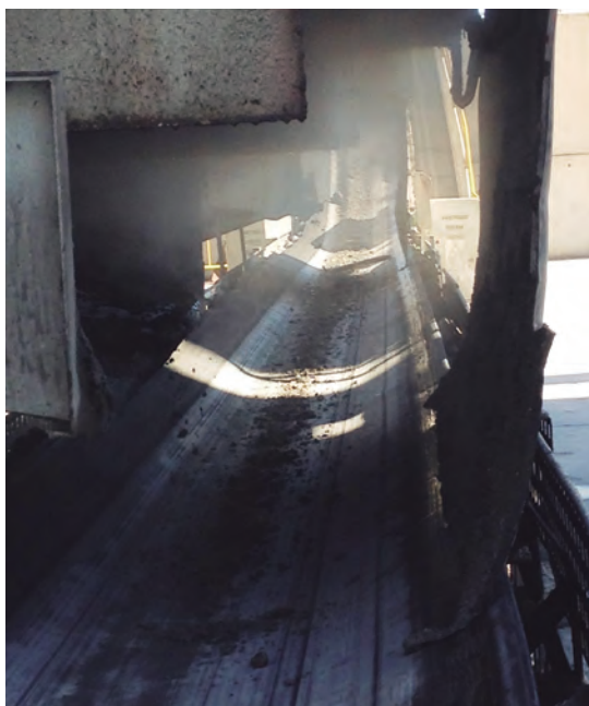
Detall de la sortida dels forns de les escòries, encara fumejant
